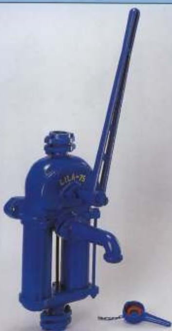
Dvouválcové stojaté pístové čerpadlo LILA 75 lze instalovat na malém prostoru a využít pro volný výtok i výtlak vody bez mechanických přiměsí o maximální teplotě 40°C. Čerpadlo tvoří dva pracovní válců o Ø 75 mm poháněně stavitelnou pákou. Variabilní konstrukce čerpadla umožňuje široké možnosti jeho využití.
