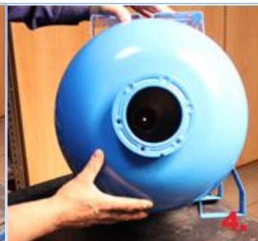
Obrázok 4 – vizuálne aj rukou skontrolovať či sa na vnútornej strane nádoby nenachádza ostrá hrana ktorá by mohla poškodzovať vak. V prípade uniknutej vody v nádobe ju necháme preschnúť. V prípade že je nádoba extra skorodovaná je nutná výmena celej nádoby.
