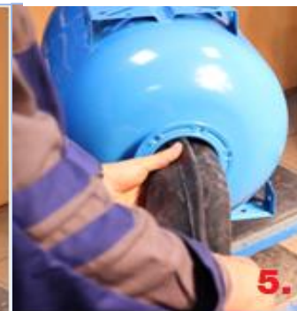
Obrázok 5 – vložiť do nádoby nový vak. V prípade nádoby objemu 50l a vyššie je potrebné zadné "uško" vaku prichytiť o zadnú prírubu na ventilke a spolu ich prestrčiť do zadného otvoru. Následne utiahnuť ventilkou príslušným kľúčom.
