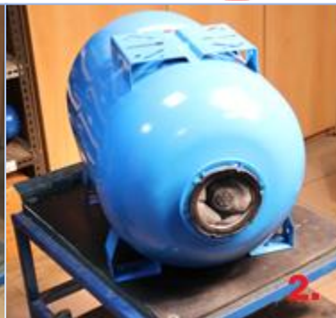
Obrázok 2 – Skrutky odložiť a demontovať prírubu tak aby sme videli vak
