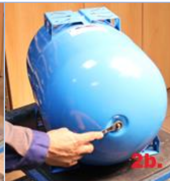
Obrázok 2b – nádrže ZILMET od objemu 50l sú uchytené aj na zadnej strane, čo zvyšuje životnosť keďže sa vak nedotýka spodnej strany nádoby. Demontujeme kľúčom č.11 zadný ventilok a uvoľníme tak vak uchytený ku ventilke zo zadnej strany
