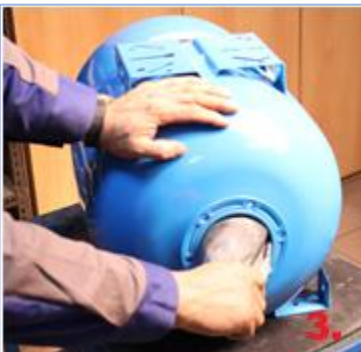
Obrázok 3 – vytiahneme poškodený vak z nádoby
