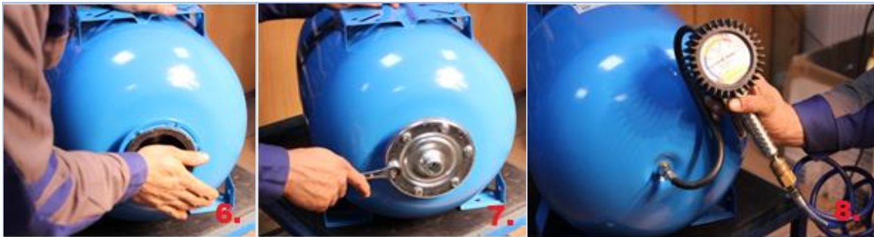
Obrázok 6 – prednú časť vaku pritlačiť na prírubovú časť nádoby tak aby predný lem bol tesnením medzi nádobou a prírubou
