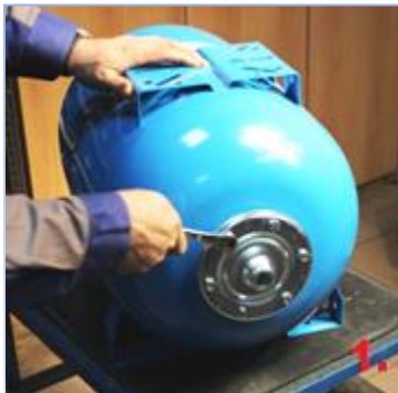
Obrázok 1 – Odtiahneme postupne všetky skrutky na príruby. Použijeme kľúč č.13
