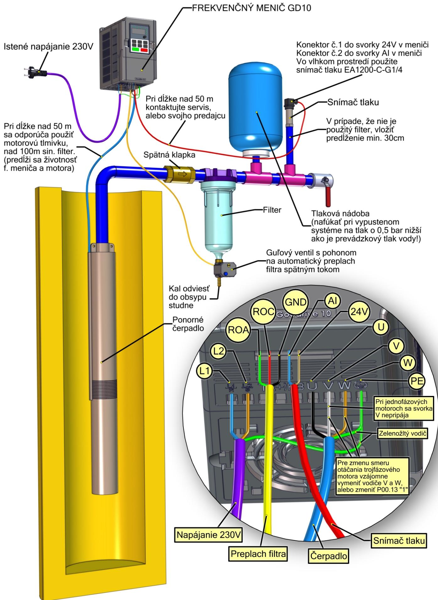
\* prierez vodičov snímača tlaku 0,5mm<sup>2</sup>, v prípade dlhej trasy použiť tieniený kábel, tienenie spojiť s PE v meniči
